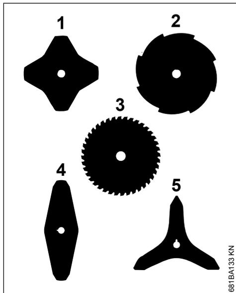
Uneltele tăietoare (1, 4, 5) pot fi orientate în orice direcție – aceste unelte tăietoare se întorc periodic pentru a evita uzura unilaterală.
