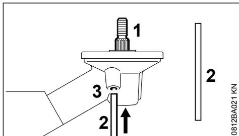
Pentru montarea și demontarea unelei tăietoare arborele (1) trebuie să fie blocat cu ajutorul dornului (2). Dornul face parte din volumul de livrare sau se furnizează ca accesoriu special.
